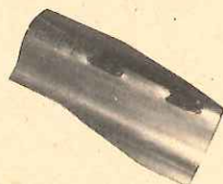
Dima tipo S per posa da sinistra a destra
