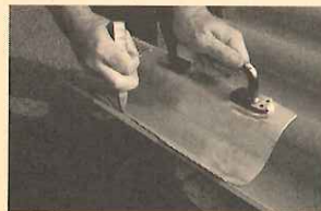
Incisione dello smusso con la punta della martellina
