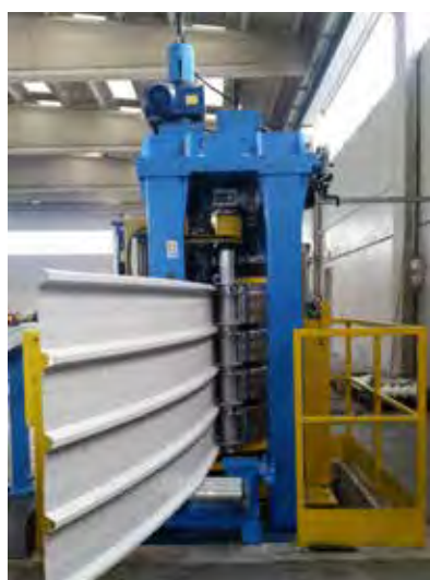
Particolare lavorazione su profilo H 40
